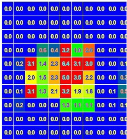
2. Messung: Druckergebnis Betonklotz mit einer EQUINOS Sattelunterlage. Durch die eingearbeitete Filzeinlage erhalten wir schon eine gute Druckentlastung
